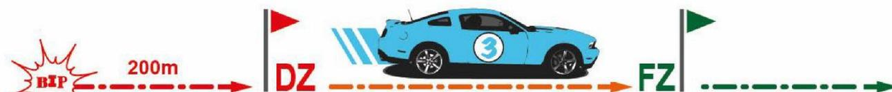
Déclenchement automatique d'une alarme visuelle et sonore 200m avant le début d'une zone à vitesse limitée « DZ-FZ ». Bip continu en cas de dépassement de la vitesse autorisée dans la zone.
